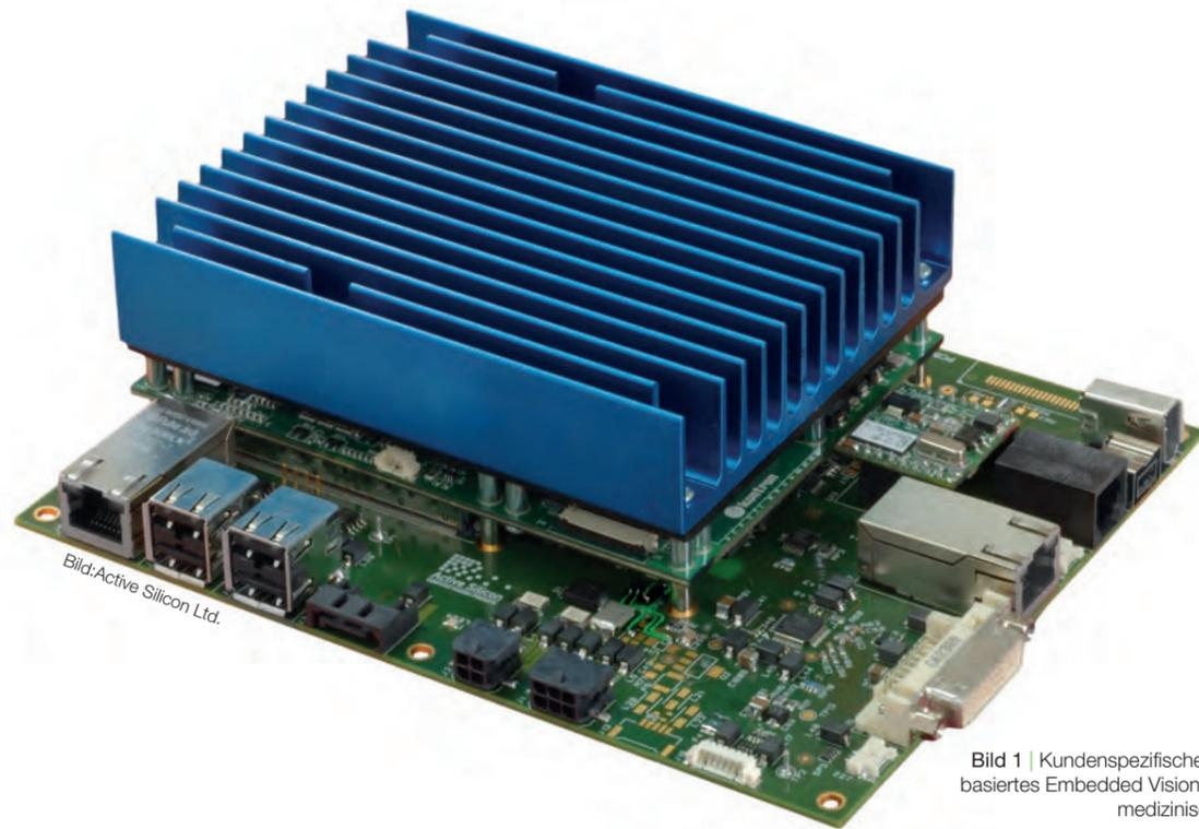
Bild 1 | Kundenspezifisches COM Express basiertes Embedded Vision System für eine medizinische Anwendung
