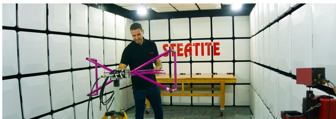
SEMI-ANECHOIC EMC TEST CHAMBER
